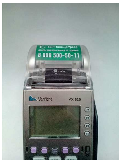
Рисунок 3. Открытие крышки отсека для бумаги
