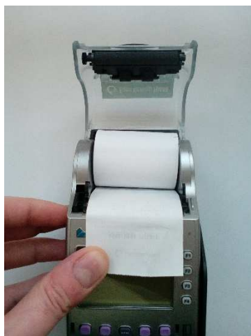
Рисунок 4. Загрузка рулона в лоток принтера
